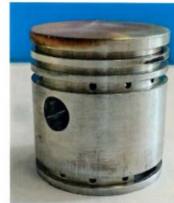
Внешний вид поршня после испытаний масла М-6з/14Д 2 к
